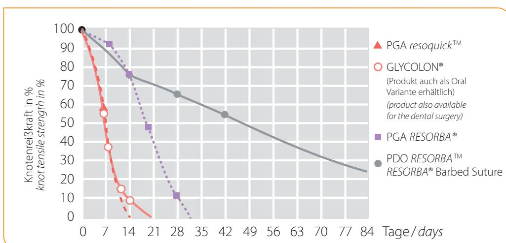
Die Abbildung zeigt eine vereinfachte Darstellung der jeweiligen Reißkraftverluste über die Zeit. Daten von GLYCOLON® und PGA RESORBA® stammen aus in-vitro Versuchen, wohingegen die Daten von PDO RESORBA™ und PGA resoquick™ aus in-vivo Versuchen stammen. Damit sind die Kurven nicht direkt miteinander vergleichbar, sondern dienen der vereinfachten visuellen Darstellung.
